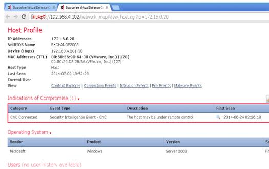
Figura 39. Detección de conexiones CnC
