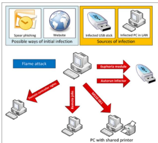
Figura 2. Métodos de propagación Flame <sup>[15]</sup>
