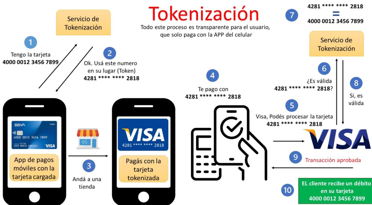
Figura 22: EL proceso pago mediante una tarjeta tokenizada
