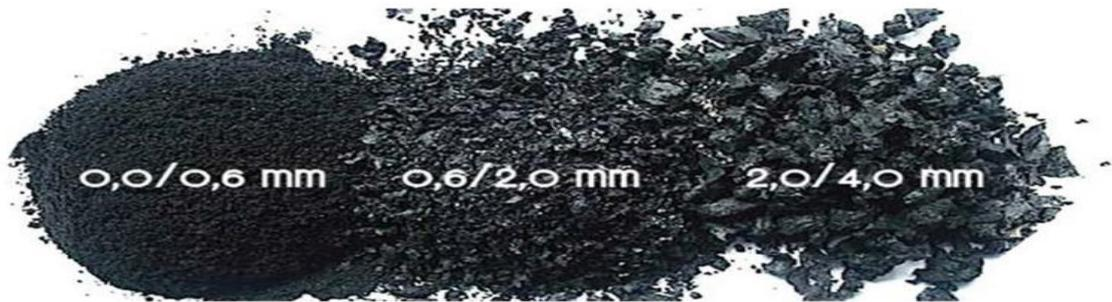
**Figura 5.** Diferentes granulometrías del caucho procedente de los NFVU.
