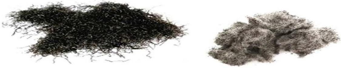
**Figura 4.** Acero y fibra textil separados durante el proceso de transformación.
