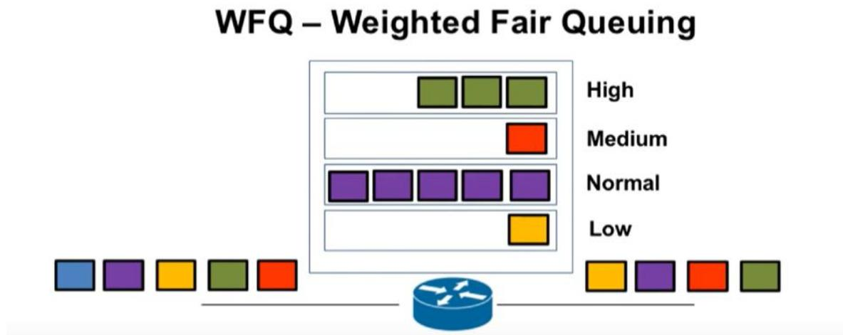
**Figura 12: Esquema de funcionamiento de una cola WFQ**
