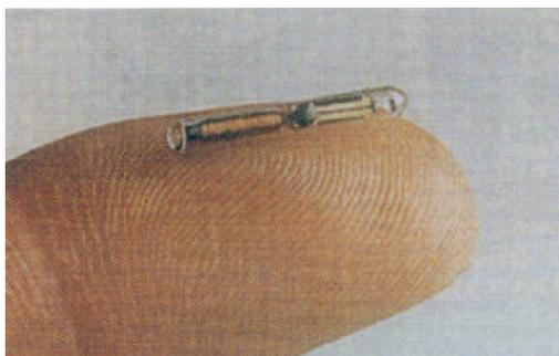
**Figura 21 - Mecanismo de identificación electrónica inyectable**
