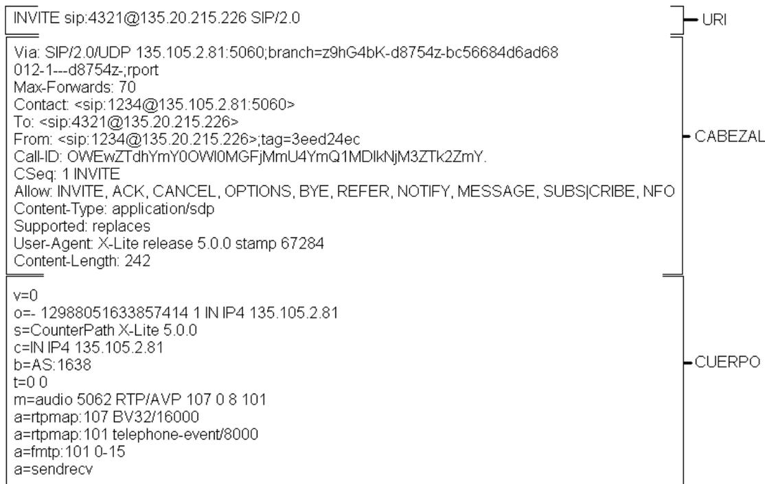
Figura.01- Partes de un mensaje SIP
