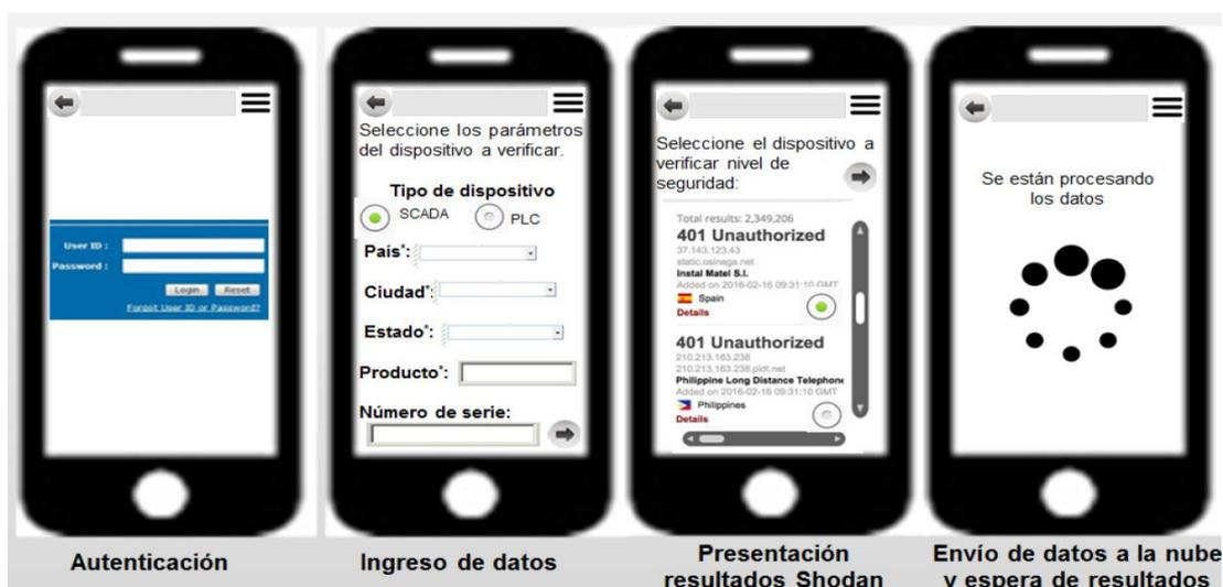
Figura 5 – Interfaz propuesta de la aplicación para definir el nivel de seguridad de un dispositivo IoT [22]
