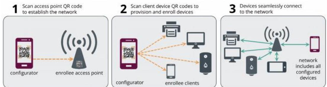
Figura 6 – Diagrama del proceso de conexión de dispositivos “Easy Connect” de WPA3
