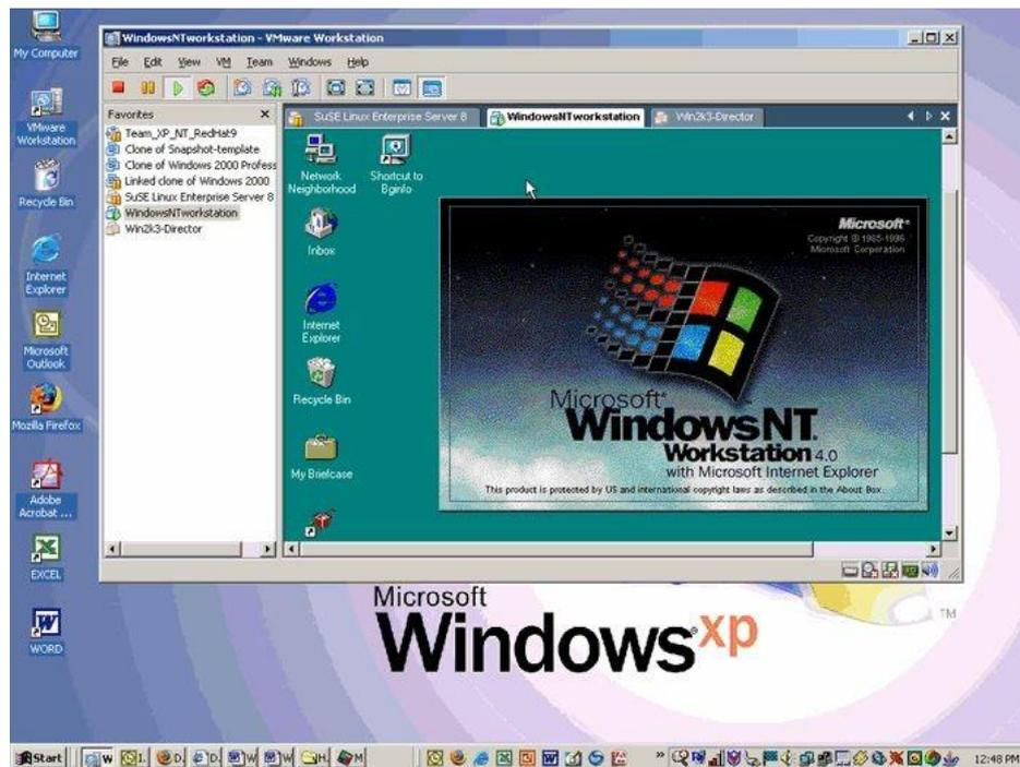
Ilustración 3: VMware Workstation, software sobre sistema operativo Windows XP, emulando otro sistema Windows Server NT, ambos funcionales y compartiendo recursos de un mismo equipo físico.
