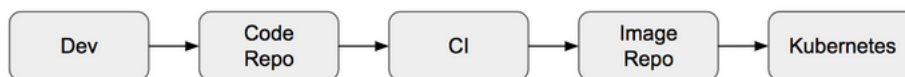
Figura 29: Pipeline o flujo de trabaja en un proceso de integración y entrega continuo (Maple, Simon, 2019).
