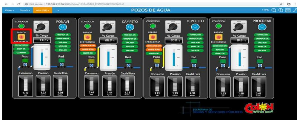
Ilustración 21. Interfaz HMI del sistema expuesto
