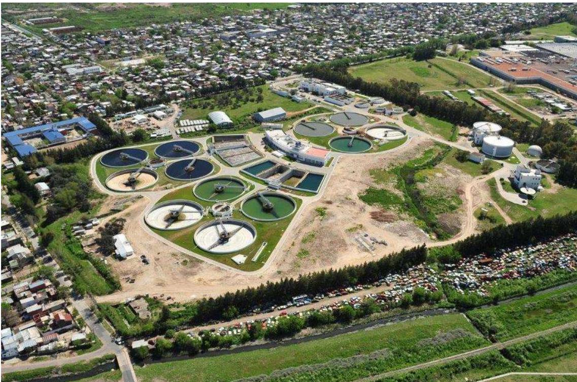
El mismo se compone de una ingeniería básica de proceso por medio de la cual procesos de depuración biológica aeróbica y anaeróbica a través de un procesamiento industrial forzado por componentes mecánicos, permite el tratamiento del fluido separando barros,
