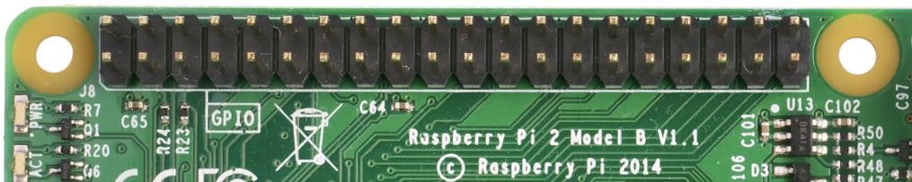
Figura 7: GPIO de una Raspberry-Pi
