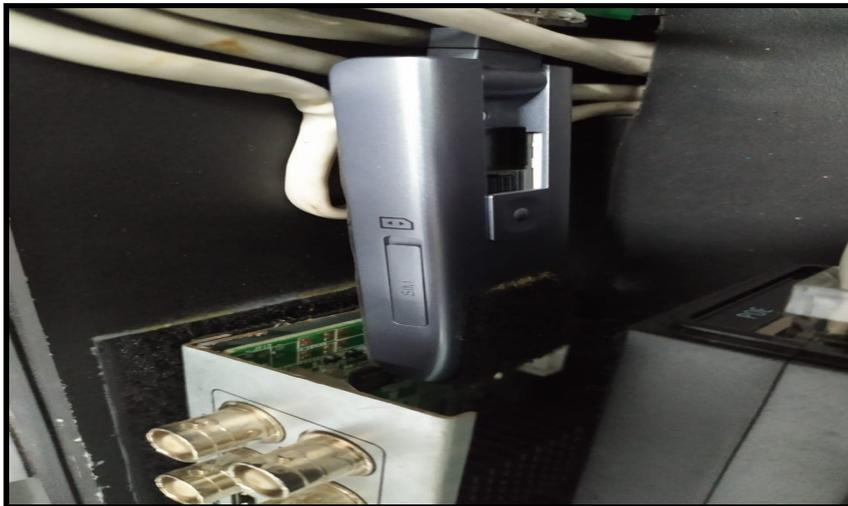
Modem Usb conectado al router, utilizando una antena externa de 35 db y con chip de datos móviles ilimitado para transmisión en tiempo real.
