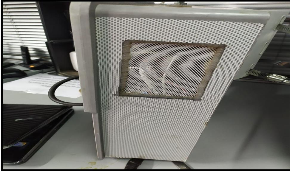
Vista lateral del equipo. Se utilizó un film microperforado para ocultar el cristal.
