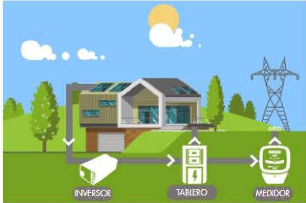
Los sistemas fotovoltaicos ON GRID o CONECTADOS A LA RED son sistemas que permiten generar energía eléctrica a través de paneles solares y la misma puede ser utilizada en el mismo establecimiento o ser subida a la RED en caso de no utilizarse. En estos casos se incorporan medidores bidireccionales que permiten saber cuánta energía se consume y cuánta se genera, permitiendo reducir la factura de electricidad a final del mes.
