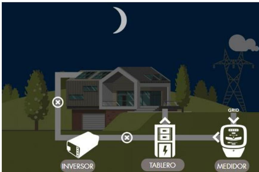
Figura 31: Ilustración del funcionamiento de los paneles solares fotovoltaicos conectados a la red eléctrica de distribución, durante la noche, sin generación de energía.
