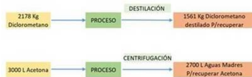
Figura 3: Punto en el proceso productivo donde se lleva a cabo el recupero de solventes.
