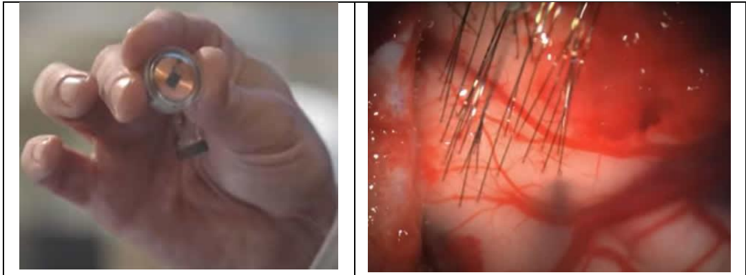
Figura 37: Vista del dispositivo BCI implantable y electrodos implantados [60]
