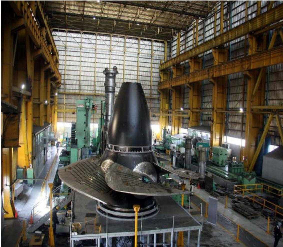
Rotor turbina hidráulica Kaplan
