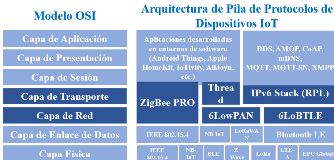
Figura 14. Protocolos de dispositivos IoT y su correlación con el Modelo OSI
