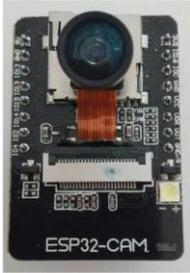
Figura 7. ESP32-CAM. Reimpreso del sitio web <https://programarfacil.com>, 2022, obtenido de <https://programarfacil.com/esp32/esp32-cam/>. Copyright 2022 por ARDUINO.
