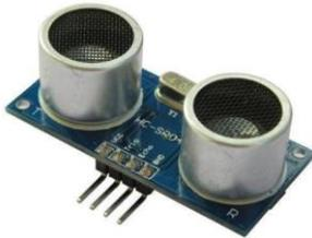
Figura 2. Sensor Ultrasonido HC-SR04. Reimpreso del sitio web
