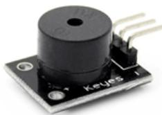
Figura 10. Buzzer pasivo. Reimpreso del sitio web <https://www.luisllamas.es>, 2022, obtenido de <https://www.luisllamas.es/reproducir-sonidos-arduino-buzzer-pasivo-altavoz/>. Copyright 2022 por ARDUINO.
