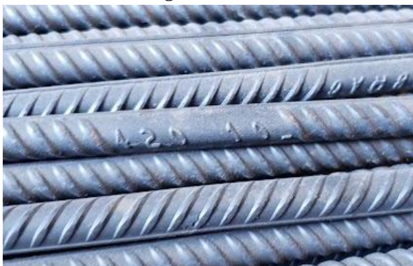
Imagen 23: Varillas de acero para hormigón armado
