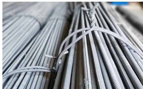
Imagen 24: Lingadas de varillas de acero
