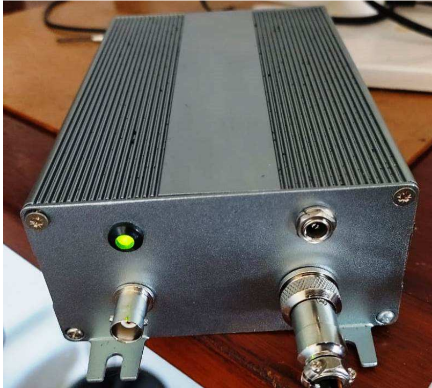
Figura 27 - Equipo Sensor que posee el Am241 y el detector Geiger-Müller
