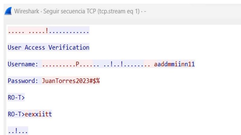
Figura 22. Mensaje Telnet enviado entre PC1 y ST01-RO-01.
