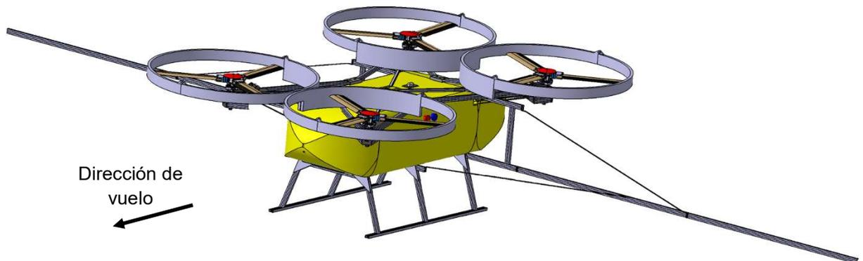
Imagen N° 11: Drone desplegado para pulverizar.
