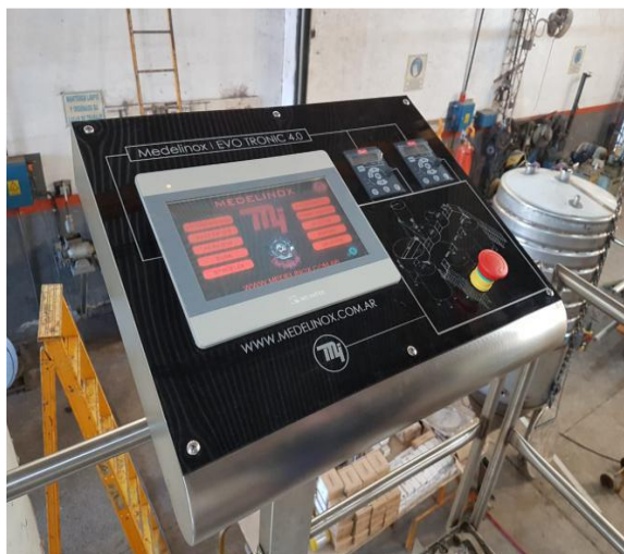
Figura 37: Sistema de control centralizado
