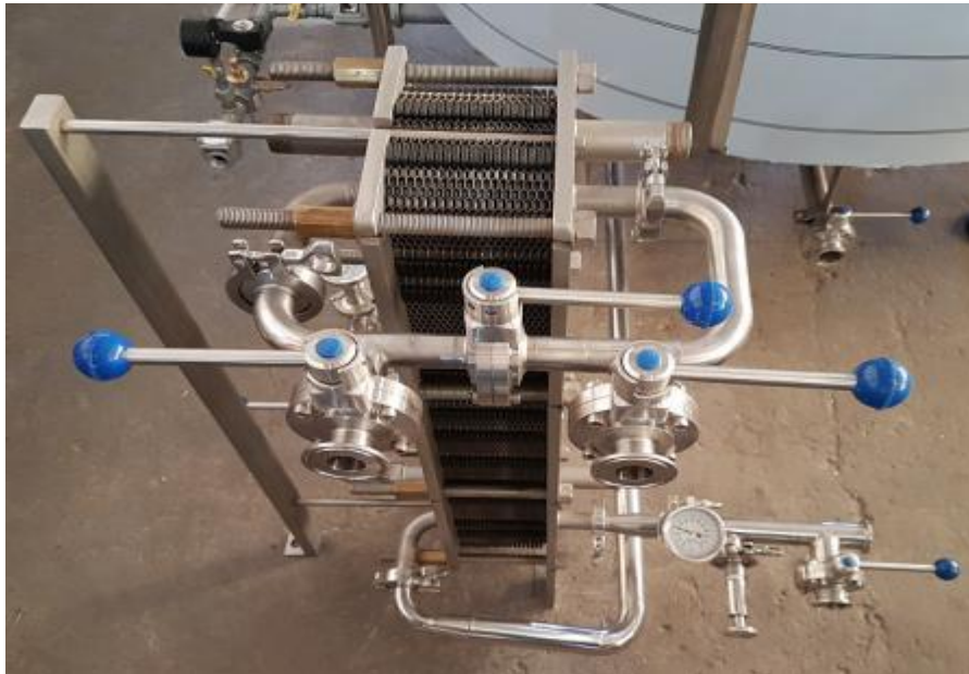
Figura 36: Intercambiador de calor
